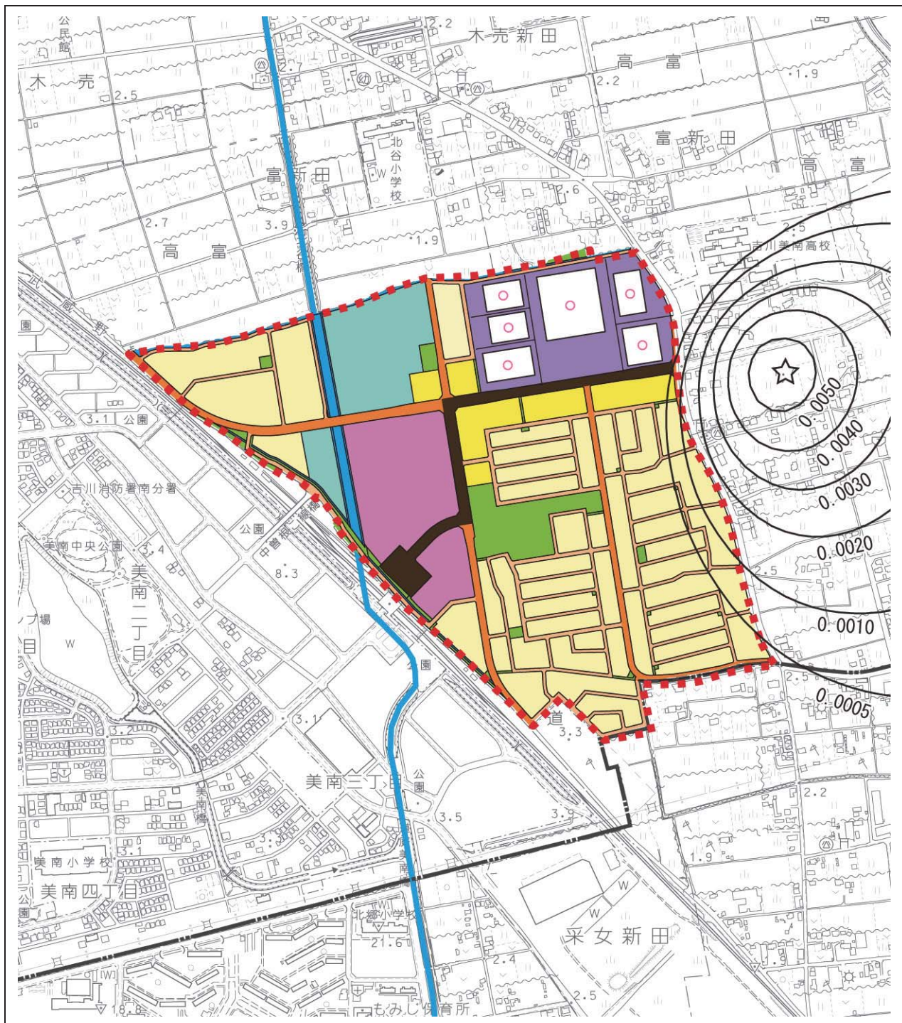
図 10-1-26(3) 施設の稼動に伴う浮遊粒子状物質（付加濃度）の 予測結果（1時間値）
