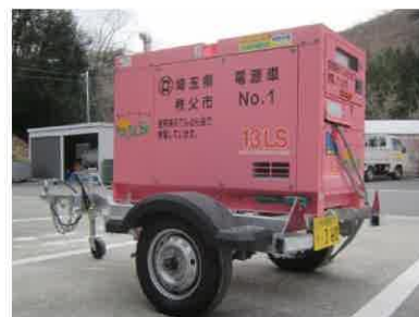
牽引式発電機 (燃料に BDF を使用)
