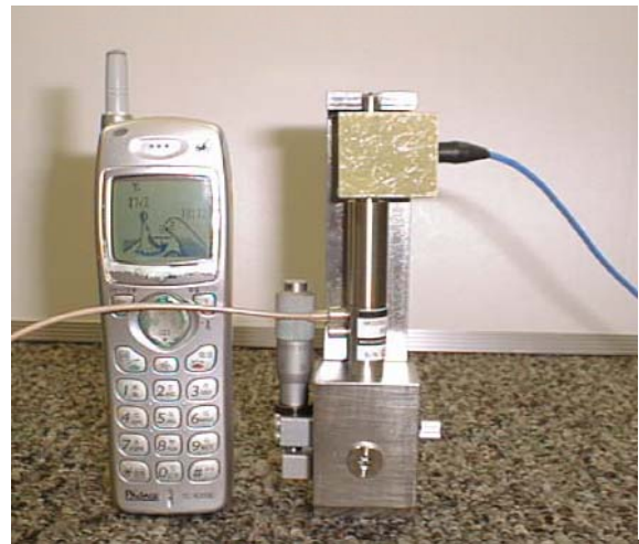
図2 試作した超微小硬さ測定機
