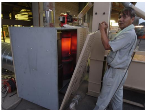
図2 吸引式温風発生器での乾燥試験
