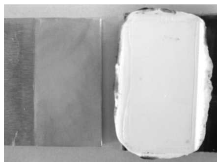
図 2 樹脂①を使用した接着材による湿式研磨アルミ板と GF-PP の誘電加熱接合
