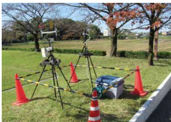
写真13-3 環境大気中の石綿濃度の測定
