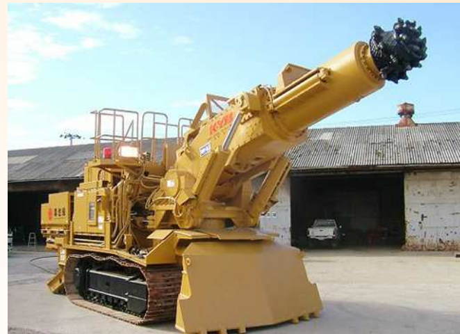
自由断面掘削機（ブームヘッダ） 【掘削作業】
