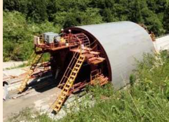
スライドセントル（鋼製移動型枠） 【覆工コンクリート施工時】
