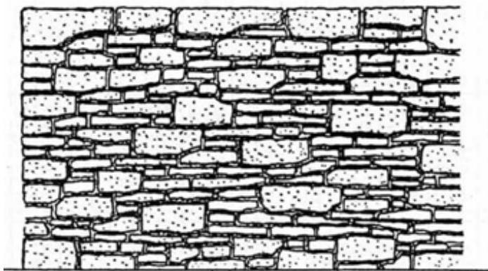
(2) 受注者は、天端石のある場合は、天端石に大きい石材を使用し、稜線が通るように施工しなければならない。
