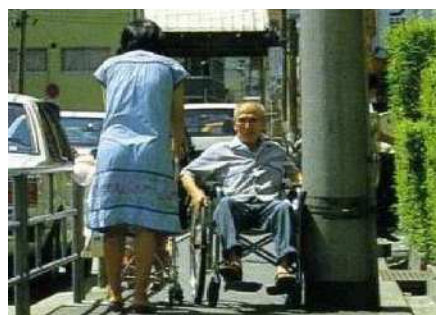
電柱が通行の支障となっている状況 (国土交通省HPより)
