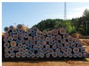
複数の丸太の径を瞬時に読み取り材積を測定
