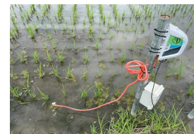
水位・水温・ 土壌温度の計測
