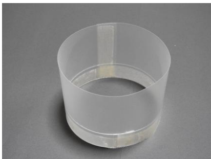
クリアファイルを利用して作成した円筒形飛行物体
