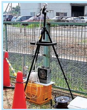
写真1-3-3 石綿除去作業周辺の石綿濃度測定
