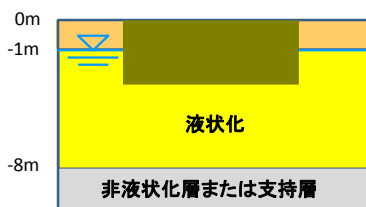
(2) 地盤の層状固化
