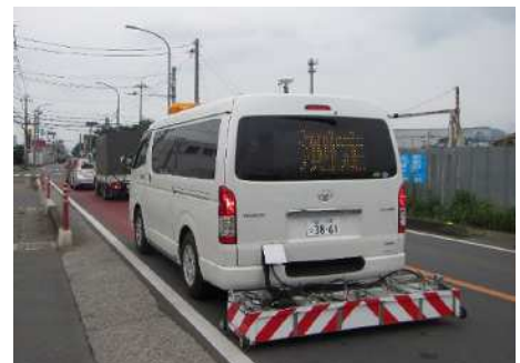
路面下空洞調査の状況
