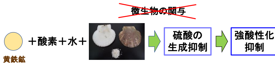
図5 環境科学国際センターが開発した対策技術の原理
