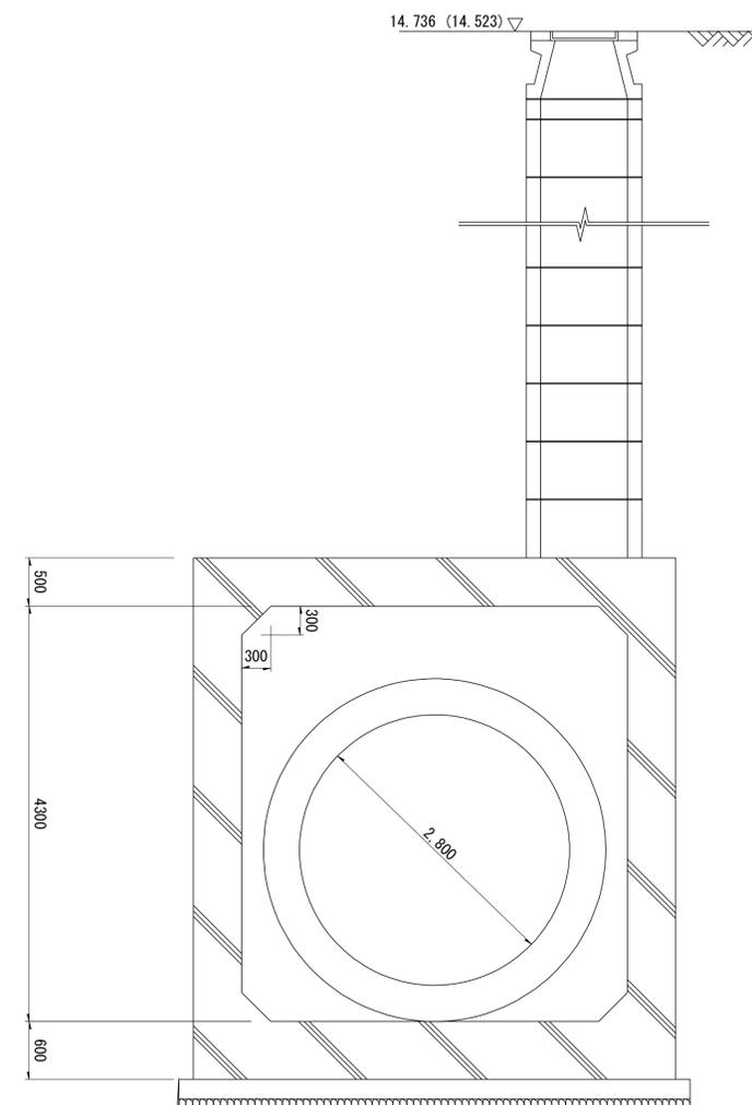
※管底高は竣工図より。※( ) 地盤高数値は、直接水準による令和二年度測量成果である。
