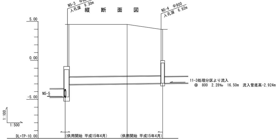
○ 1000 1.89‰ 101.92m 推進工法用鉄筋コンクリート管 ○ 900 2.27‰ 62.91m 推進工法用鉄筋コンクリート管
