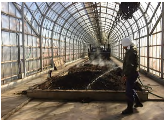
処理水を堆肥材料に散布します
