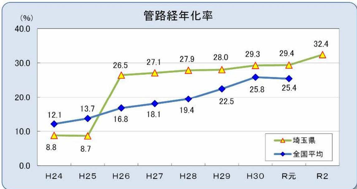
$$\text{管路経年化率 (\%)} = \frac{\text{法定耐用年数を超過している管路延長}}{\text{管路延長}} \times 100$$
