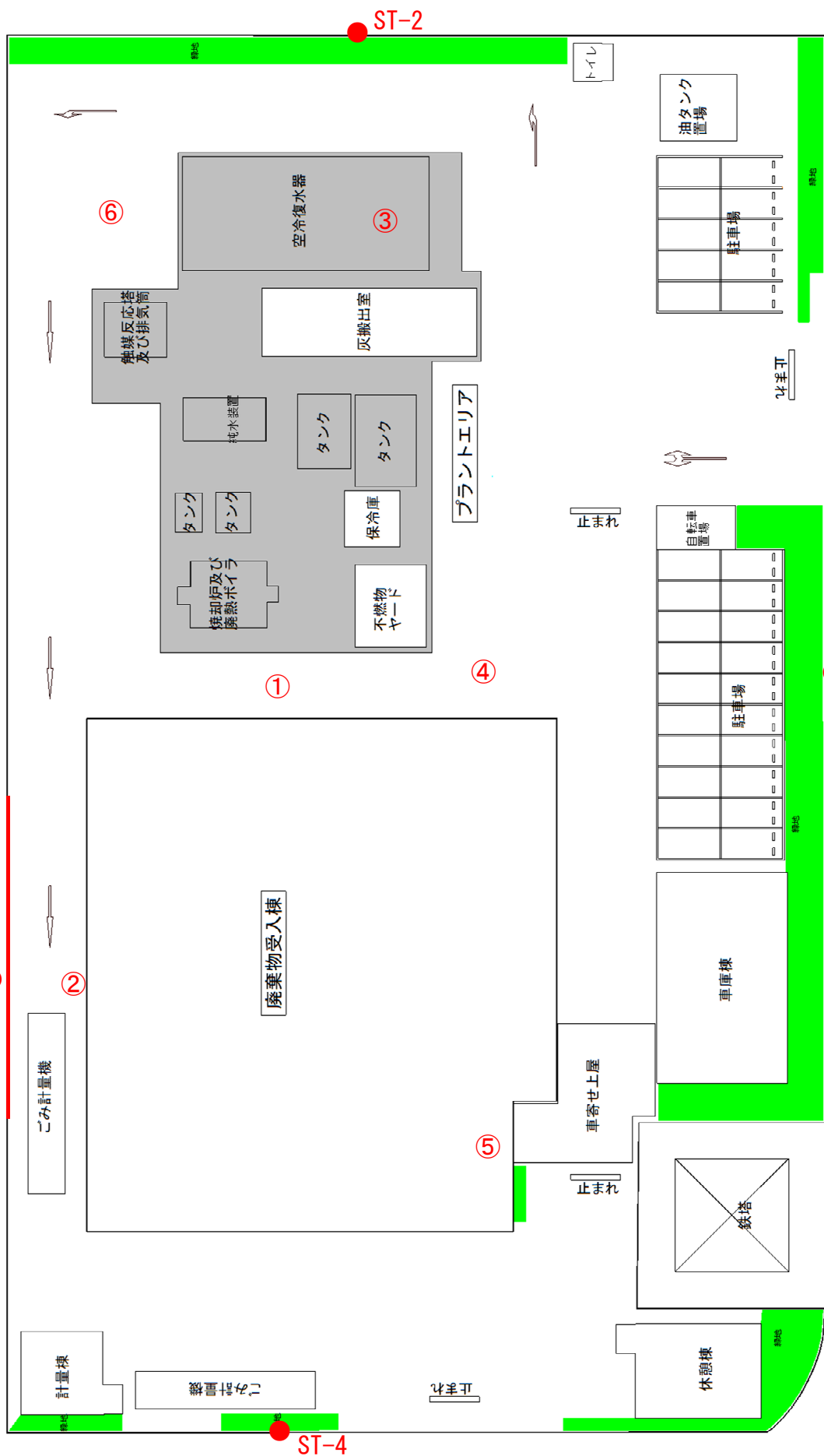
図 9-3-4 建設機械の稼働に伴う振動に係る主要な建設機械の配置と建物及び仮囲いの位置
