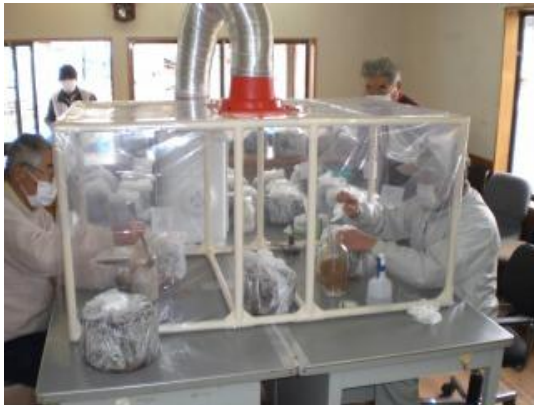
写真 2 自作クリーンベンチと作業風景 (ときがわ町役場製作)
