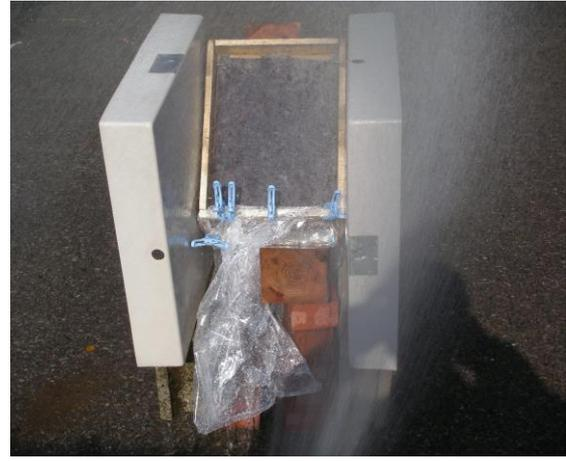
写真6 生分解性防草シートの勾配による透水性実験の実施状況
