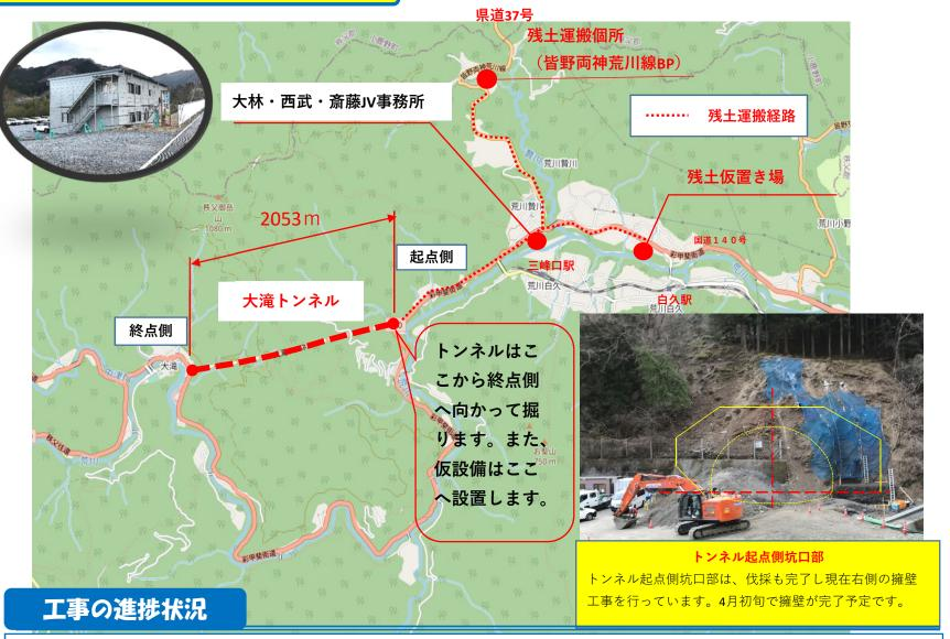
大滝トンネル工事も2月1日より起点側坑口で樹木の伐採、仮囲いの設置を行いました。現在はトンネルを掘るための仮設備(吹付コンクリート設備・機械等を動かすための受電設備・汚れた水をきれいにするための濁水処理設備等)の設置を進めています。
