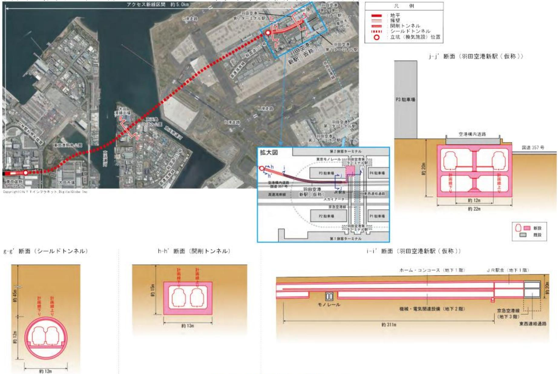
図 3.3.2-4 アクセス新線区間における断面図等
