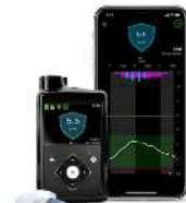
Automated Insulin Delivery (AID) 持続血糖モニター連動インスリンポンプ
