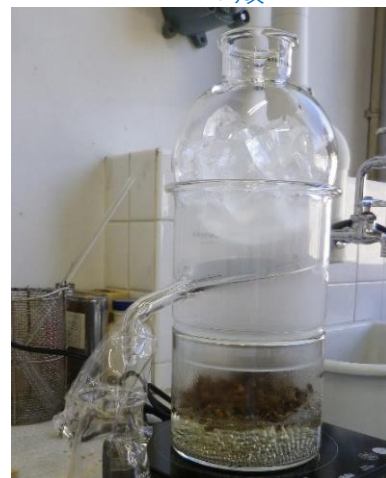
香り成分の水蒸気蒸留
