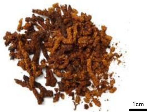
図2 フラス(褐色のカリントウ状で比較的硬い)
