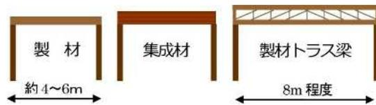
大梁は、小梁の架け方によって負担する荷重が変わるため、梁せいの大きさに影響することがあります。一般的には、スパンの短手方向に小梁を架けると大梁の負担が大きくなるため梁せいが大きくなり、スパンの長手方向に小梁を架けると大梁の負担は小さくなるため梁せいが小さくなります。
