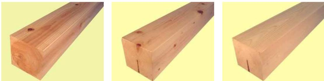
また、材面の仕上げ方法も、製材挽きのまま、モルダーがけ、プレーナーがけ、サンダー仕上げ、超仕上げ（超カンナ仕上げ）など、種類があります。最終的に納品される木材の仕上げについても、製材工場やプレカット工場等で可能な方法を確認し、特記仕様書などに記載しておく必要があります。
