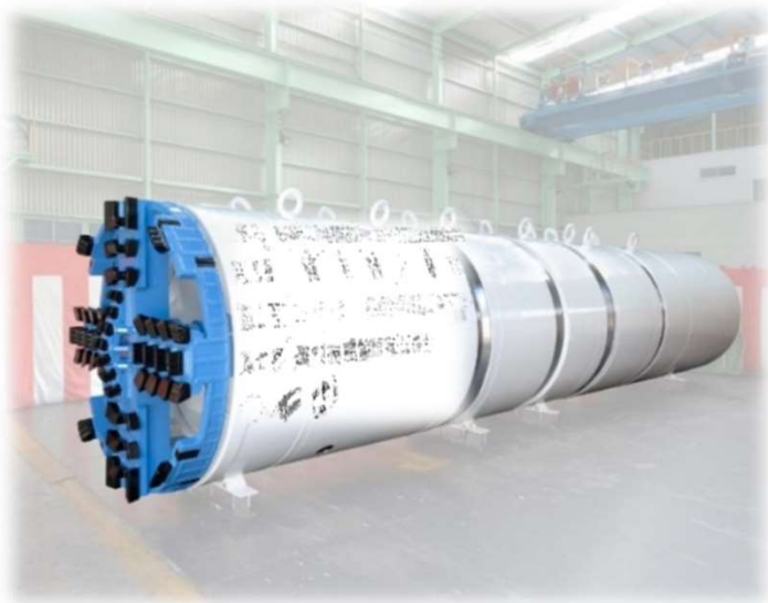
大規模水道管の布設時に使用する機械 (写真：シールドマシン)
