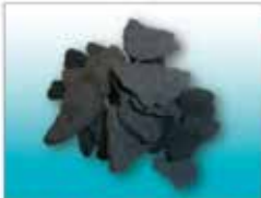
浄水場脱水ケーキ
