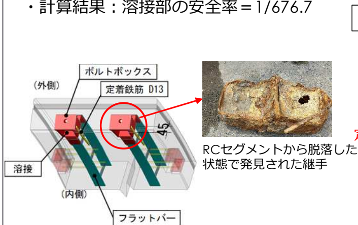
図5.15 セグメント間継手の詳細と脱落した継手
