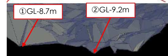
図5.18 レーザー測量による陥没穴の検証
