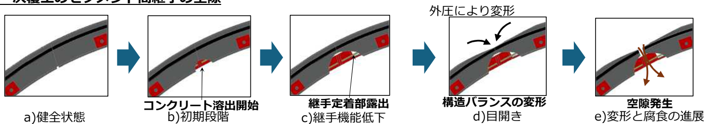
図5.7 セグメント間継手の空隙イメージ
