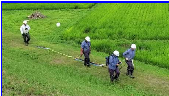
①改良版牽引式電気探査機器による調査風景
