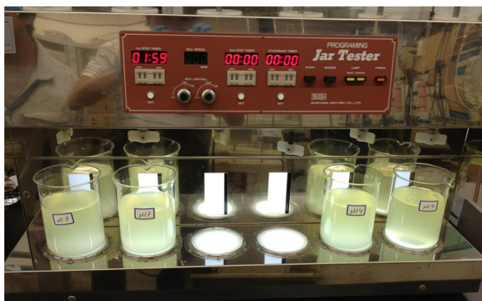
写真2 ジャーテストによる水処理再現実験
