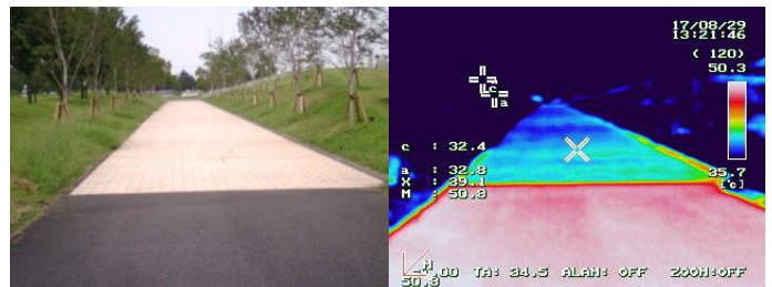
図3 暑熱対策を施した場所での、可視画像（左図）及び赤外画像（右図）。高反射性舗装を行った歩道（奥）と通常の舗装（手前）。
