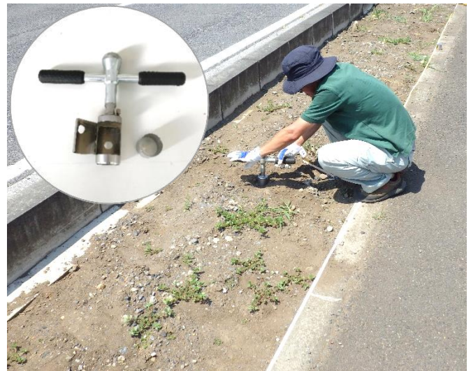
写真2 植樹帯の土壌を採取するCESSの職員。採土器(左上)を用いることで表層から5cm深さの土壌が採取できる。
