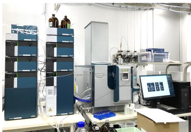
写真3 測定に用いた装置:液体クロマトグラフ飛行時間型質量分析計(Liquid Chromatograph-Time Of Flight Mass Spectrometer, LC-TOFMS)。
