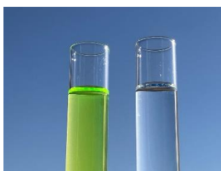
図1 フルオレセイン溶液 左：10 mg/L 右：0.00005 mg/L 左は耳かき1杯の粉を1Lの水に溶かしたレベル。右は冬季の河川水中濃度レベル。
