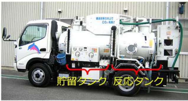
図3 汚泥濃縮車(写真は株式会社モリタエコノスより)
