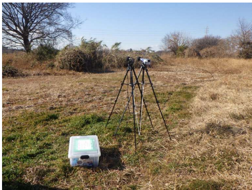
環境騒音・低周波音調査状況
