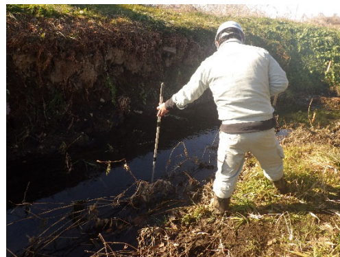
流速、流量調査状況
