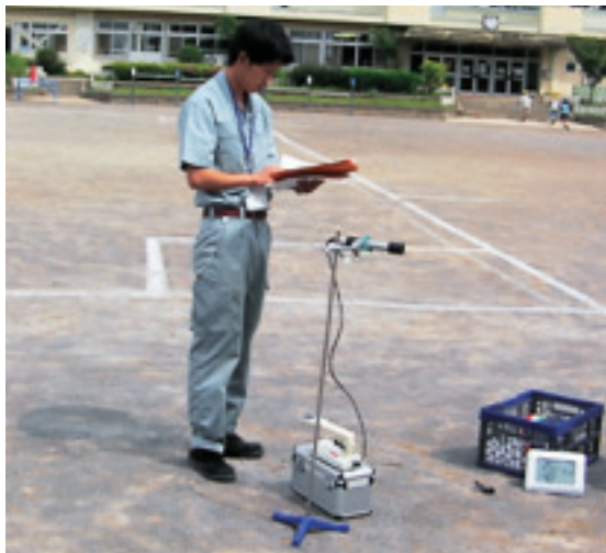
写真2 空間放射線量の測定
