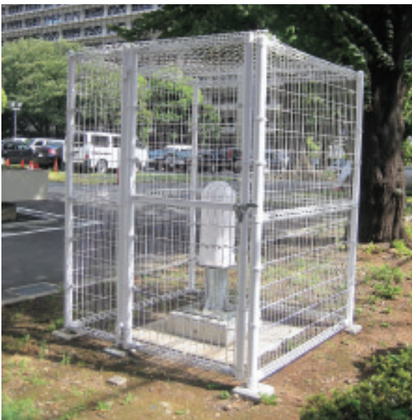
写真1 県庁へ設置されたモニタリングポスト（さいたま市）
