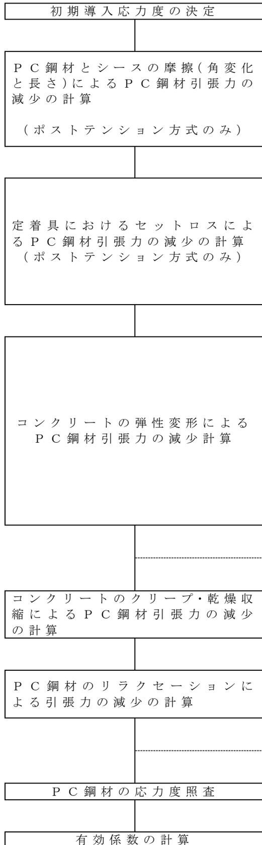
摩擦によるPC鋼材引張力の減少は、主としてPC鋼材とシースとの摩擦によって生じるが、工法によっては定着具の摩擦とジャッキ内部の摩擦があるので、これらの摩擦による影響についても考慮する必要がある。
