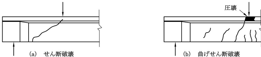
図5.3.6 PC部材のせん断破壊の形式
