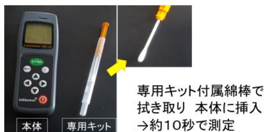
検査箇所のATP検査値 (測定単位RLU:Relative Light Unit)を数字で表示
