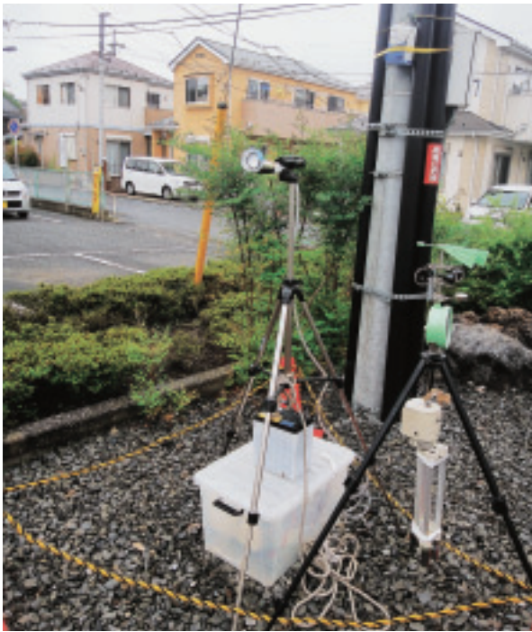
写真1-3-3 環境大気中の石綿濃度の測定
