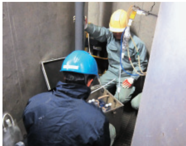
写真1-3-4 排出ガス中のダイオキシン類濃度の測定
