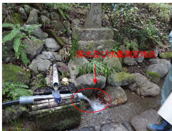
塩ビパイプ先から採水及び水量の測定を行った
