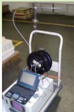
工場内のVOC測定
