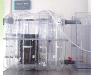
処理の高度化を目指す合併浄化槽模型 最新排水処理方法の実験装置
