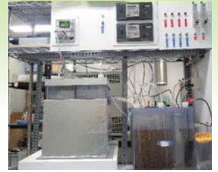
処理の高度化を目指す合併浄化槽模型 最新排水処理方法の実験装置
