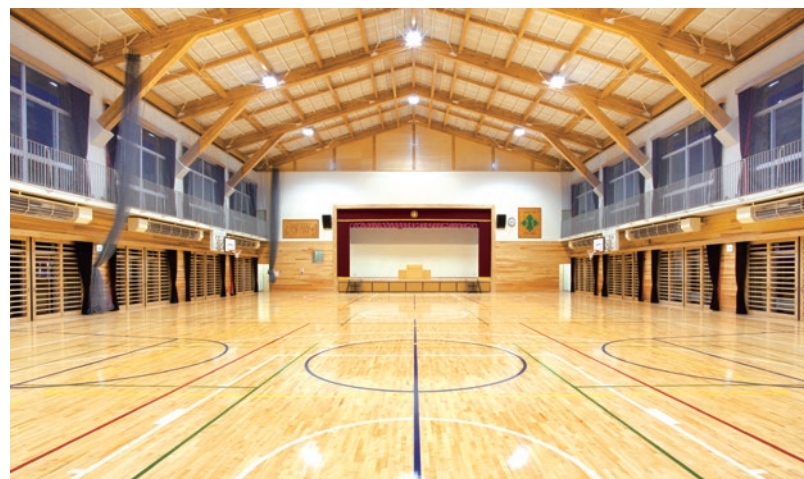
壁材：埼玉県産のスギ無垢板、床材：国産カバ集成材
