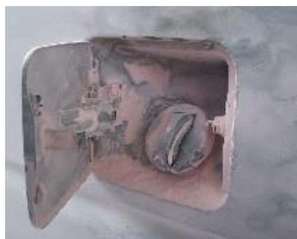
静電気火花による火災で焼損した給油口の例
