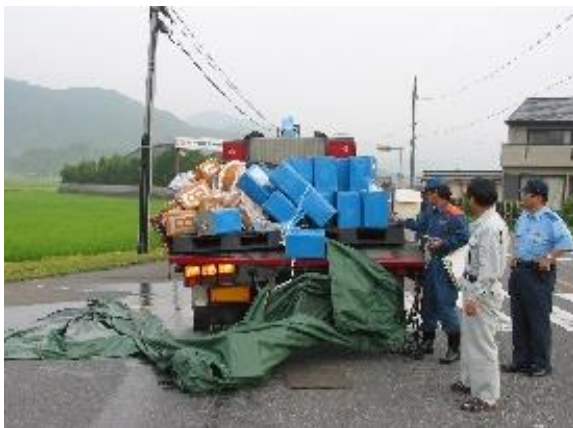
危険物容器が荷崩れしたことによる漏えいの事故例
