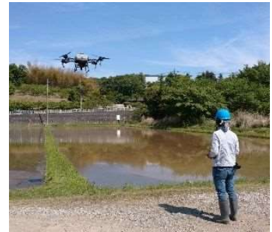
ドローンによる水稻直播作業
